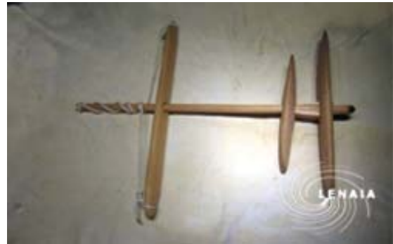
Abb.: Aufgewickelter Pumpenbohrapparat mit zwei Schwungplatten (Versuche 2005).
