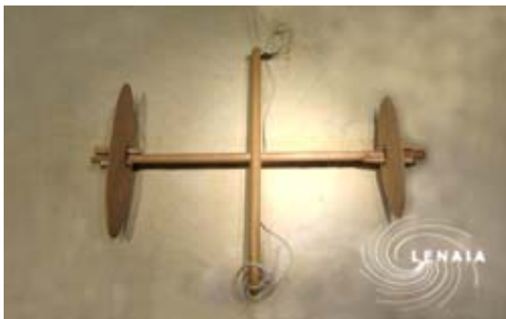
Abb.: Bohrset mit zwei Schwungplatten während der Zwischenlagerung (Versuche 2005).
