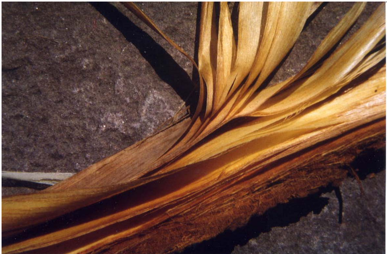
Abb. 2 Nach etwa zwei Monaten Rotten in Wasser und gründlichem Spülen lassen sich zunächst die inneren Bast­schichten ablösen und trennen, am besten in feuchtem Zustand.
